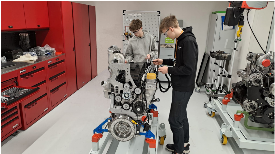
Arsi Auvinen (vas.) ja Eemeli Raunio purkavat 6-sylinteristä dieselmoottoria AGCO-Powerin moottorityöpajassa.
